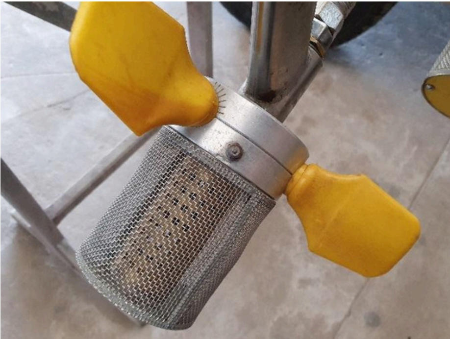
Figura 12. Possibilidades de ajuste do ângulo das pás dos atomizadores rotativos. FONTE: Wellington Carvalho.
