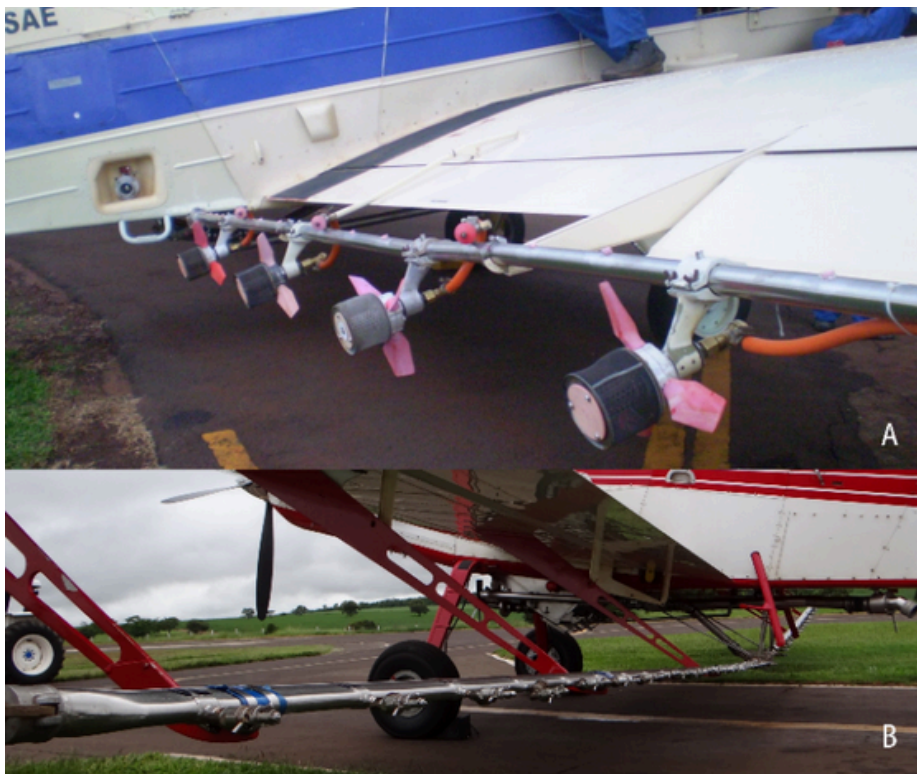
Figura 5. Barra cilíndrica instalada no bordo de fuga da asa (A). Barra aerofólia rebaixada. Fonte: Alfran Tellechea Martini; Wellington Carvalho.
