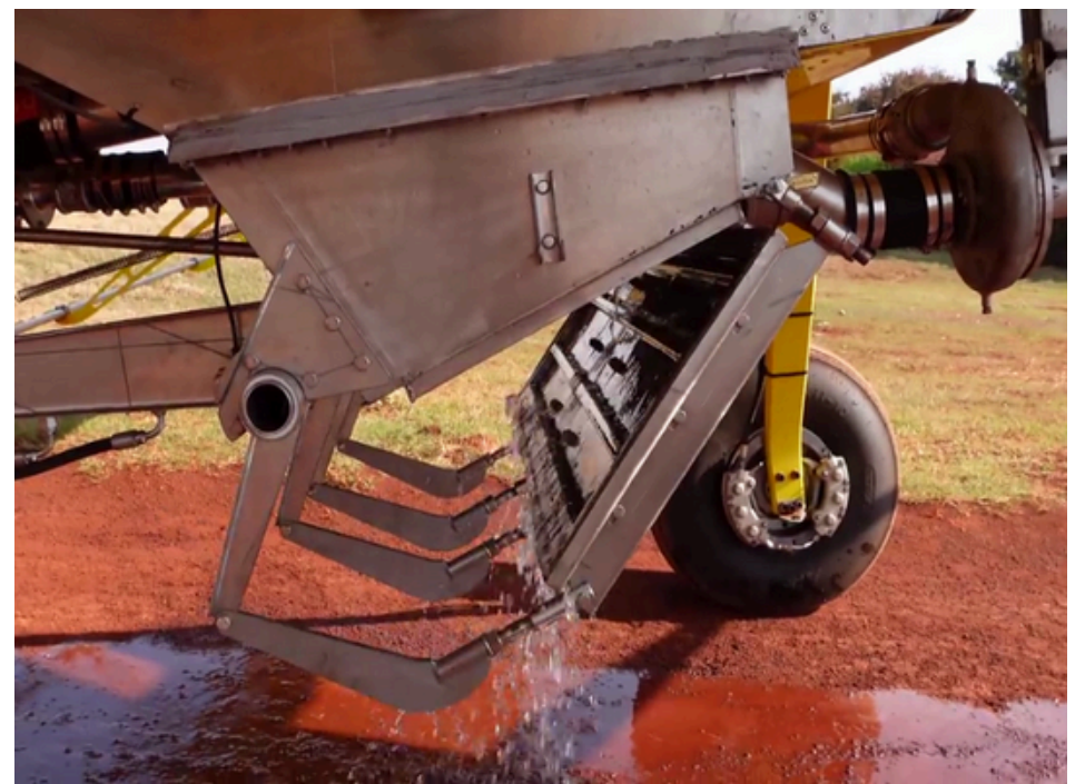
Figura 1. Comporta de alijamento. Fonte: Zanoni Equipamentos.
