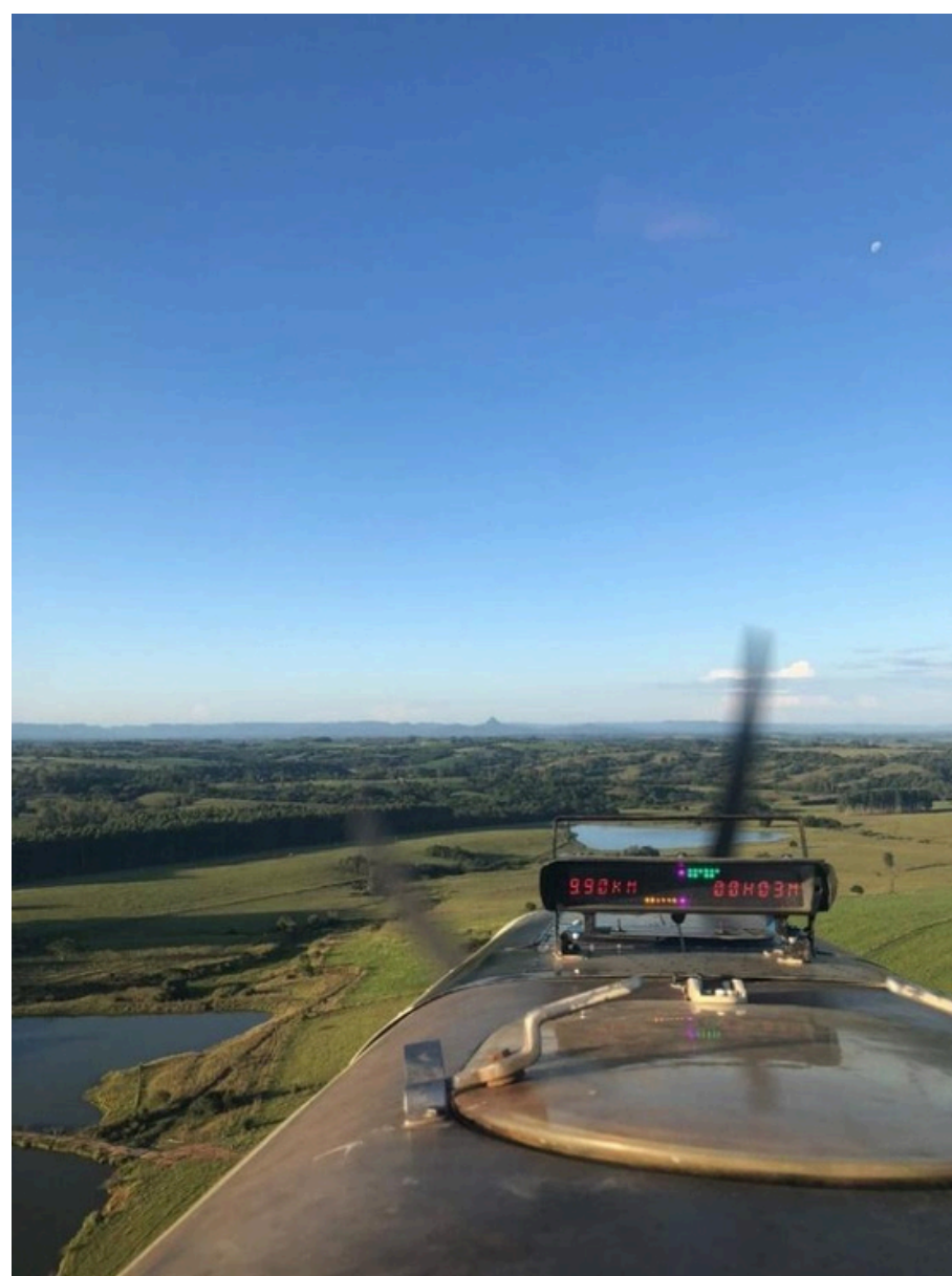
Figura 4. Barra de luzes externa para balizamento da aeronave agrícola com uso do DGPS. Fonte: Caio Kämpf.
