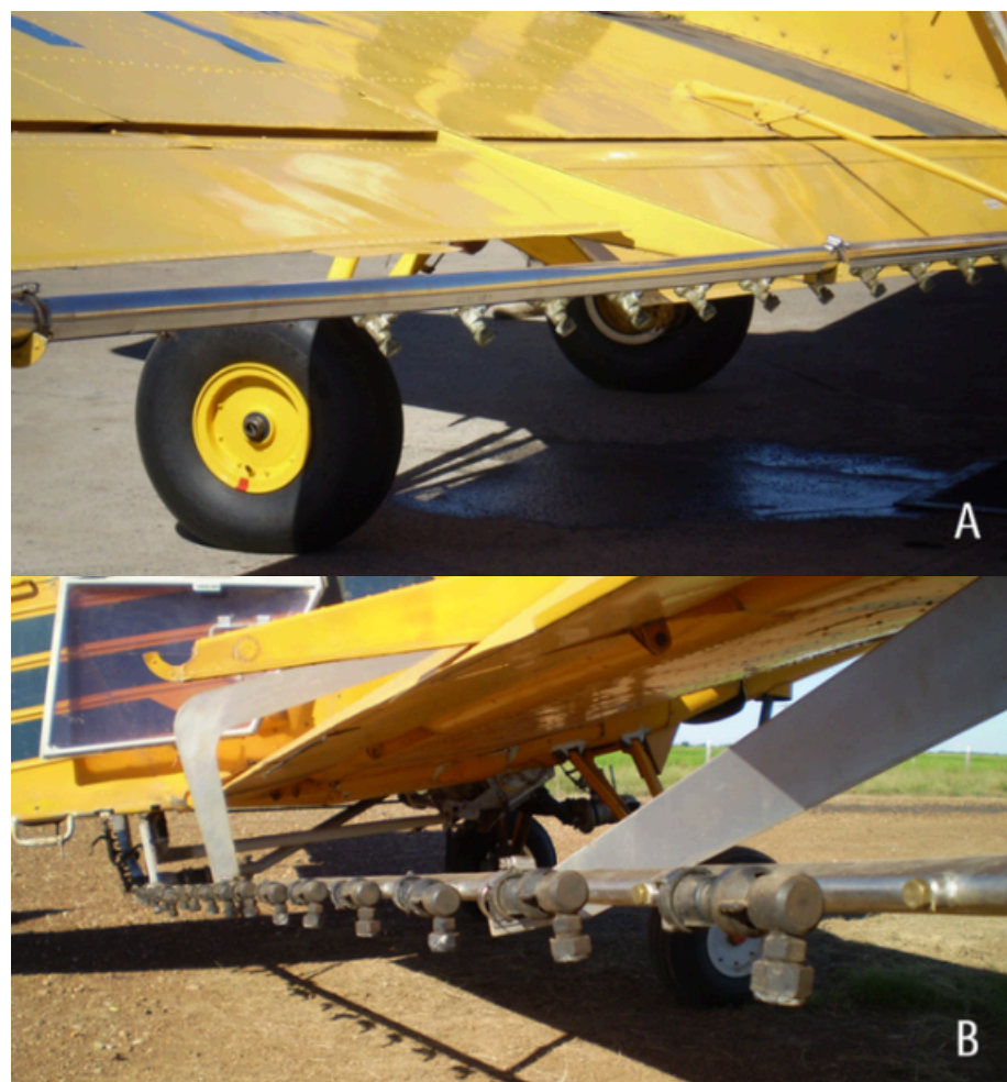
Figura 7B. Pontas de jato cônico com ângulo de 135° na barra (A). Pontas de jato cônico com ângulo de 90° na barra (B). Fonte: Alfran Tellechea Martini.
