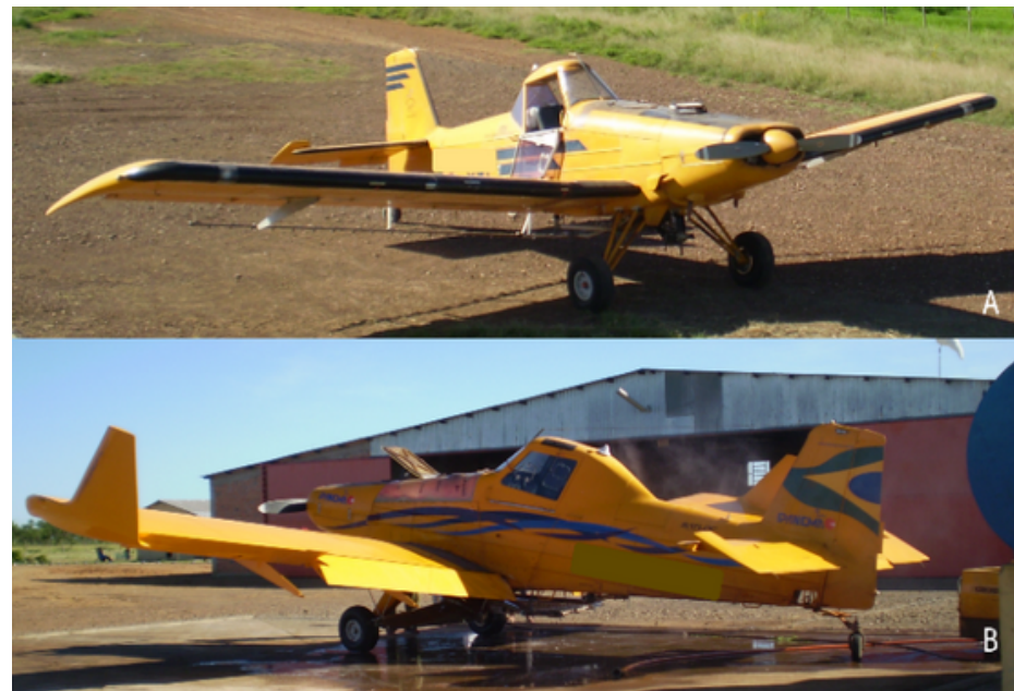
Figura 6. Aeronave com ponta de as do tipo gaivota (A). Aeronave com ponta de asa do tipo “Winglet” (B). Fonte: Alfran Tellechea Martini.
