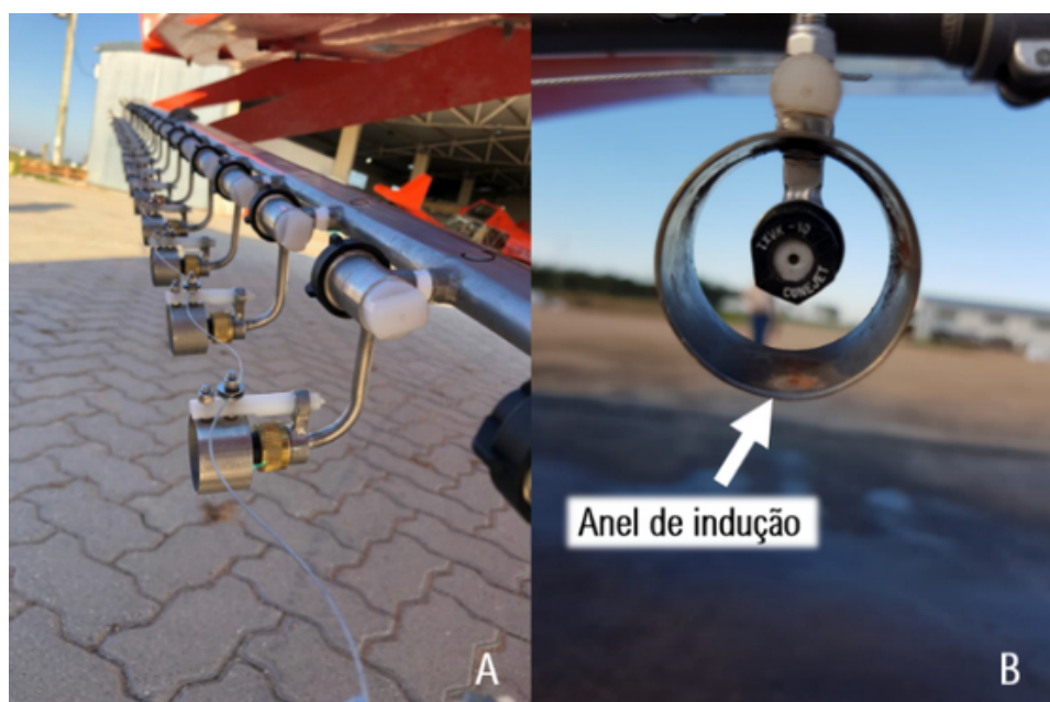
Figura 14. Equipamento eletrostático montado na barra de pulverização (A). Anel de indução para carregamento das gotas (B). Fonte: Zanoni Equipamentos; Taim Aero Agrícola.
