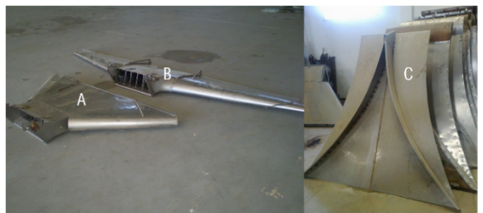
Figura 2. Difusores de sólidos. Venturi (A); Swathmaster (B); Tetraédrico (C). Fonte: Alfran Tellechea Martini.
