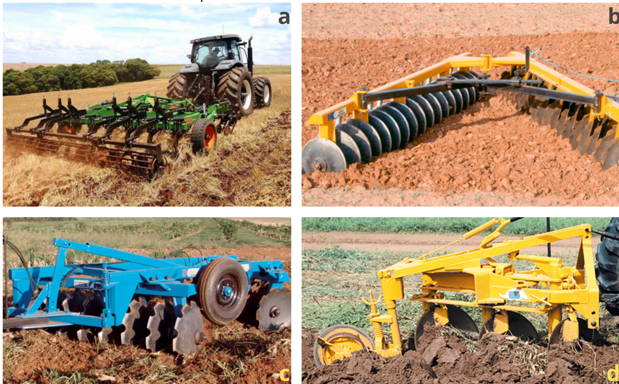
Figura 4. Equipamentos de preparo primário e periódico do solo. Escarificadores (a), Grades niveladoras (b), grades aradoras (c) e arado de discos reversível (d).
