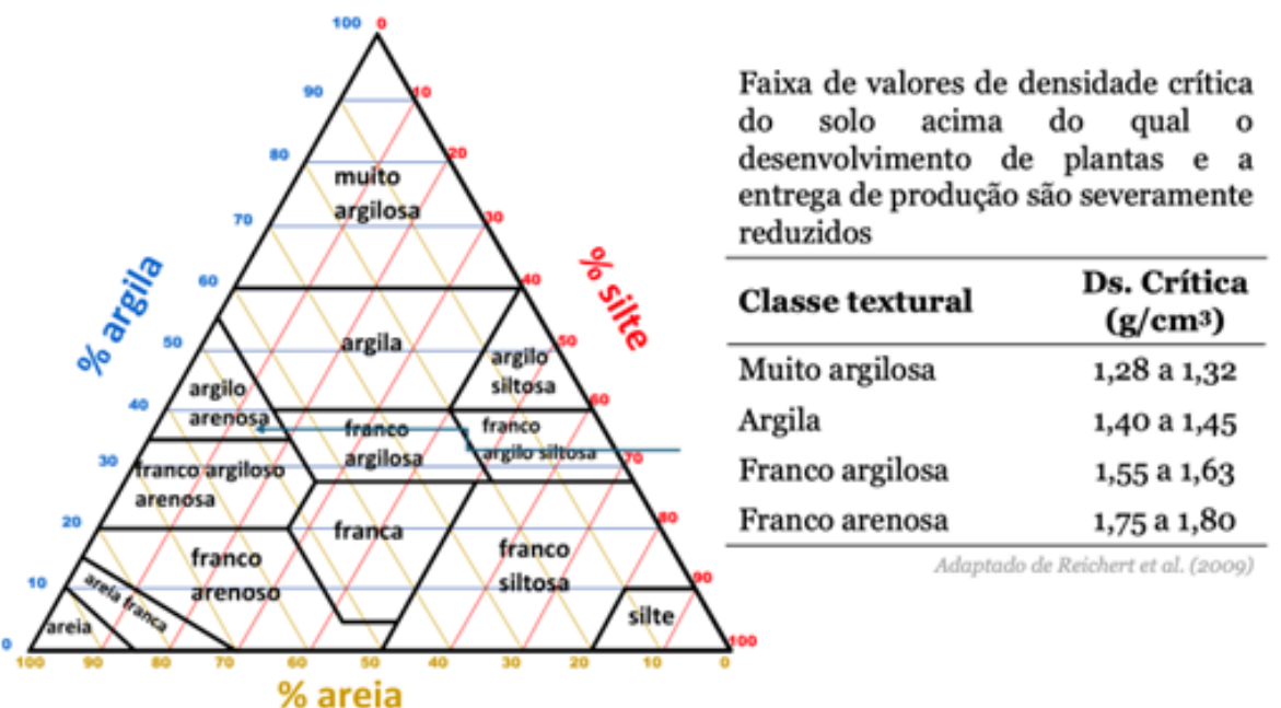
Figura 3. Diagrama utilizado para enquadramento das frações de areia, silte e argila em classes texturais.
