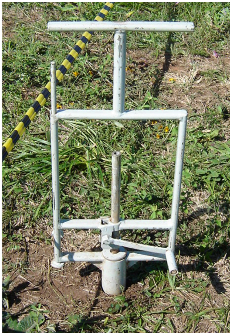
Figura 2. Trado para coleta de amostras de solo com estrutura preservada, utilizadas para determinações da densidade, porosidade, grau de saturação entre outros mais. Fonte: Prof. Renato Levien.
